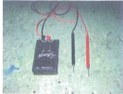
写真1 通電チェッカー
