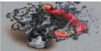
写真8 亜鉛着火状況（終了時）
