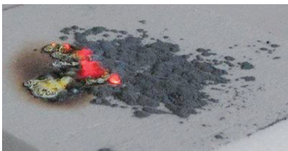
写真7 亜鉛着火状況（開始時）
