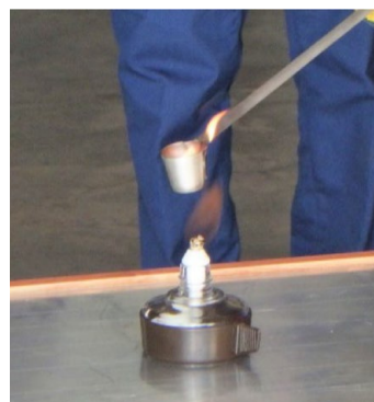
加熱した危険物の引火実験
