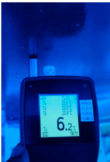
図.11 施工環境の確認
