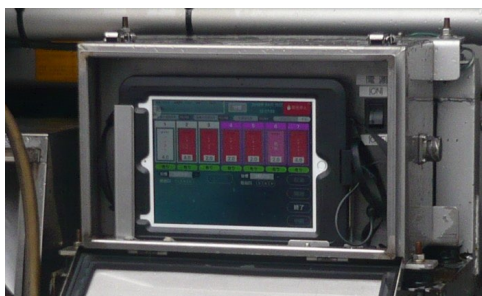
従来型操作盤へタブレット端末を装着
