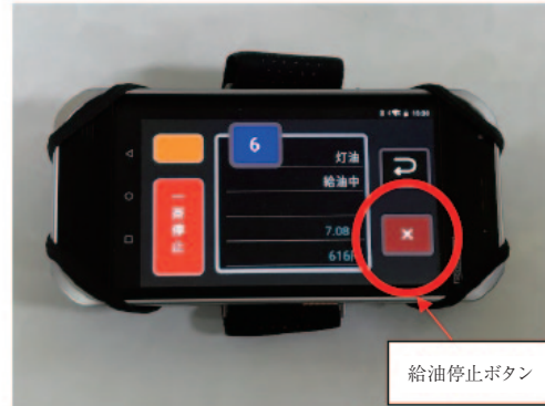
図3* 可搬式の制御機器(給油中)
