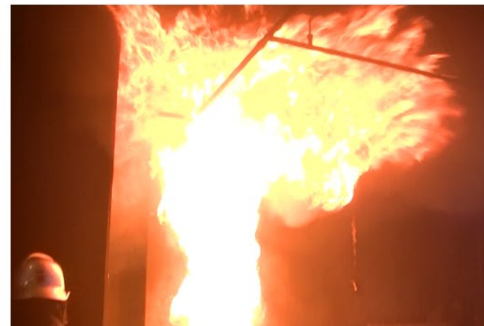
てんぷら油燃焼時に水をかけた状況
