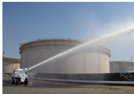
毎分4,000リットルを超える放水砲ロボット (ウォーター・キャノン)からの放水
