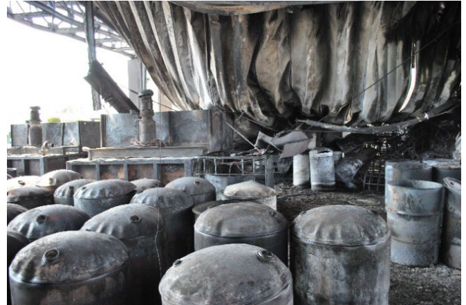
写真2 変形したドラム容器
