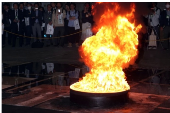
軽油の燃焼実験 (消防研究センター)
