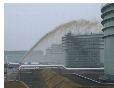
写真 5 大容量泡放射試験の状況
