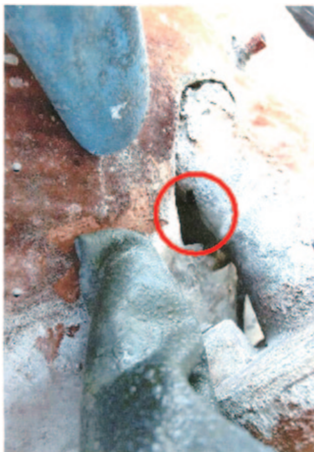
開孔したノズル (ノズルの上から撮影、丸印は開孔部)
