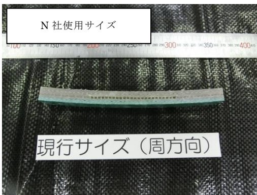
写真9 試験片寸法の検討用試験片 (現行サイズ・周方向)
