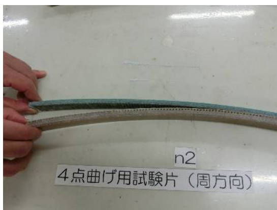
写真 1 検知層と FRP 層の剥離状況
