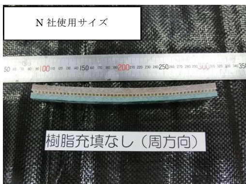
写真11 検知層を固定しない試験片の状況等確認用試験片 (周方向)
