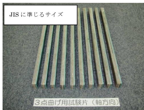
写真 4 試験方法の検討用試験片 (3点曲げ用・軸方向)
