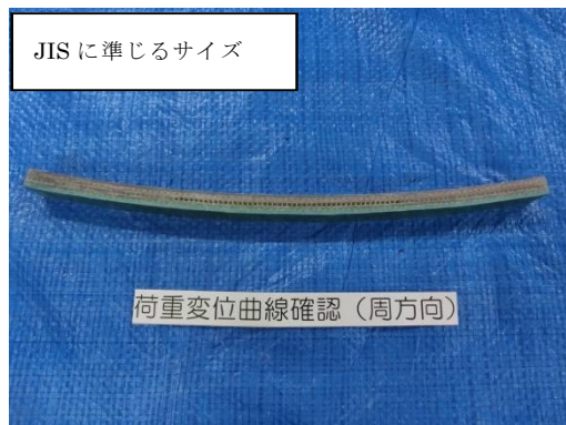
写真 1 荷重変位曲線上における変化の確認用試験片 (周方向)
