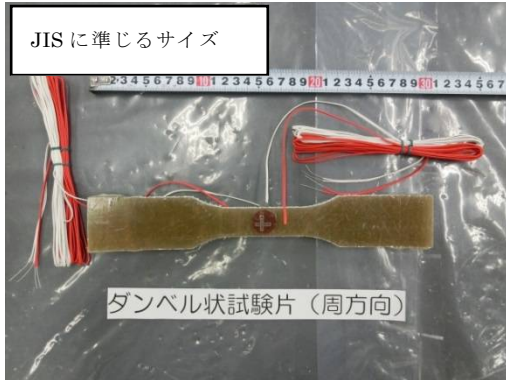
写真7 試験片形状の検討用試験片 (ダンベル状・周方向)
