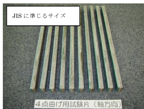
写真 6 試験方法の検討用試験片 (4点曲げ用・軸方向)
