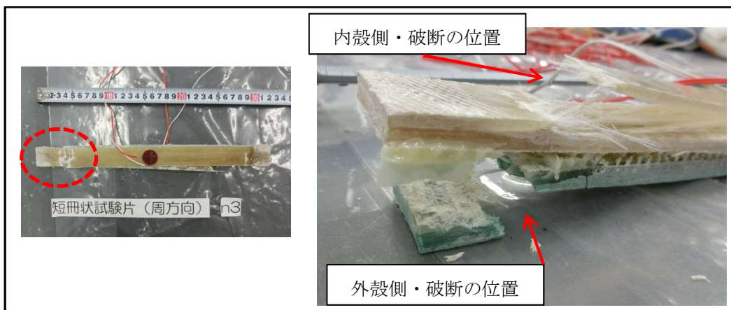
図 20 試験後の状況（短冊状試験片・周方向・n3）
