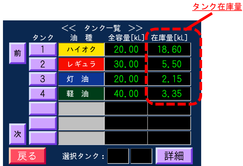
写真2. 3. 4 車載コンピューターのタンク在庫量表示画面（C社製品）
