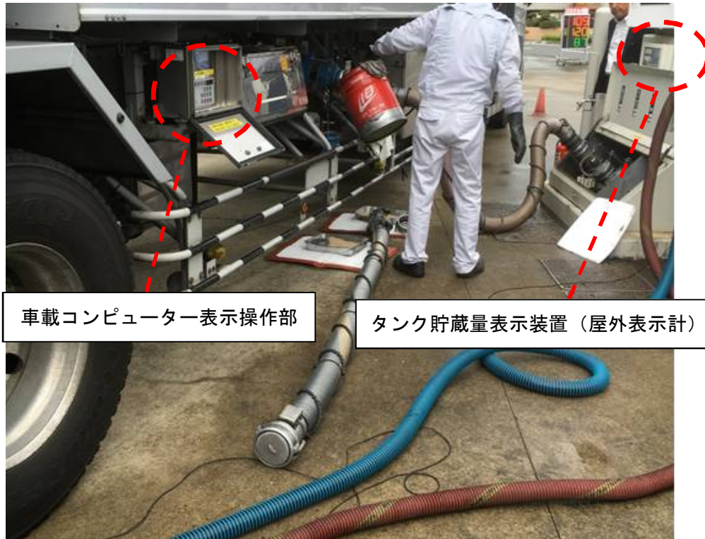
写真 2. 3. 7 タンク貯蔵量表示装置と車載コンピューター表示操作部の位置状況
