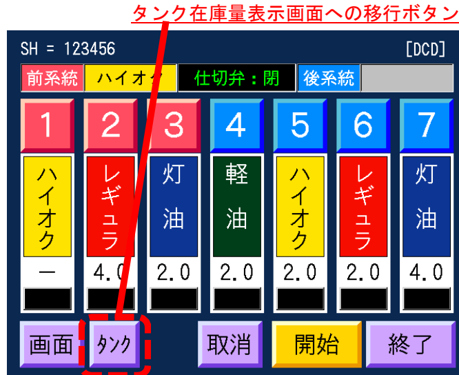
写真2. 3. 3 車載コンピューターの荷卸し表示画面（C社製品）
