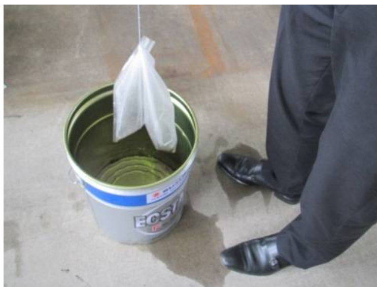
写真 2. 2 乾燥砂に対する水又は油の吸着状況
